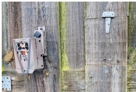
Deux modèles de pièges sont utilisés : le Browning (modèle BTC-8E-HP4) et le Reconyx (Hyperfire 2). Ces appareils sont configurés en mode longue portée pour capturer des vidéos de 30 secondes à chaque déclenchement, avec le Reconyx prenant également 5 photos supplémentaires. Les pièges sont relevés une fois par semaine pour le Marais Ouest, et toutes les deux semaines pour la Lagune Avocette et le Grand Large, afin de réduire les perturbations dans ces zones (Fig 25.).
